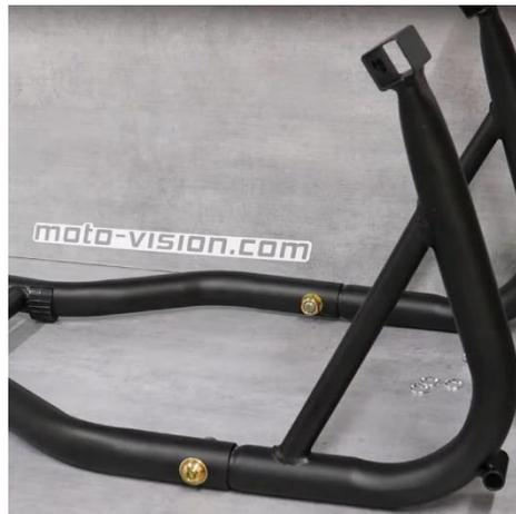
4 - Passez maintenant au montage des roues en passant les tiges aux trous prévus à l'extrémité de chaque côté de la béquille.
