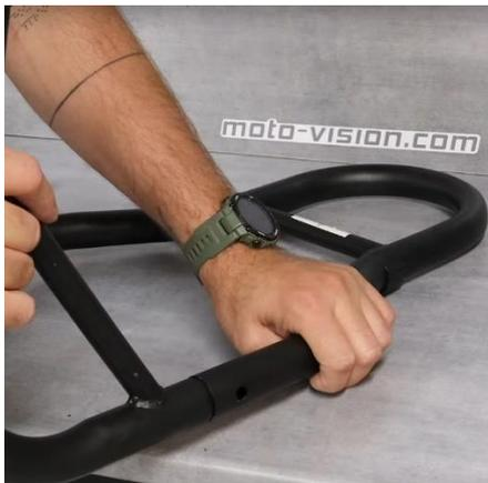
2 - Pour les maintenir ensemble, utilisez la vis que vous maintenez en ajoutant d'un côté une rondelle plate, et de l'autre côté une rondelle plate et un écrou.
