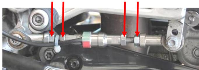
Assurez vous que le capteur et la tige ne touchent rien lors des mouvements Placez le capteur loin de toute source de chaleur. Assurez-vous que le fil fait une légère boucle pour laisser de la marge lorsque le capteur est sollicité La garantie ne couvre pas les fils endommagés.
