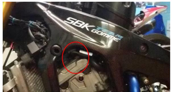
4.5 Localisez le capteur de vitesse. Il est à côté du contacteur de béquille, juste derrière le réservoir du côté gauche. Il a 3 fils: jaune/vert, rose/noir, rose/noir.
