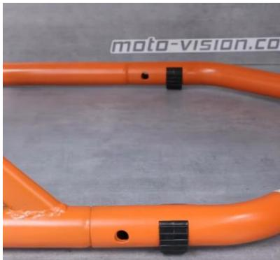
2 - Pour les maintenir ensemble, utilisez la vis que vous maintenez en ajoutant d'un côté une rondelle plate, et de l'autre côté une rondelle plate et un écrou. Serrez bien le tout. Afin de visser plus facilement l'écrou, c'est le moment de sortir votre **clef plate de 17**.
