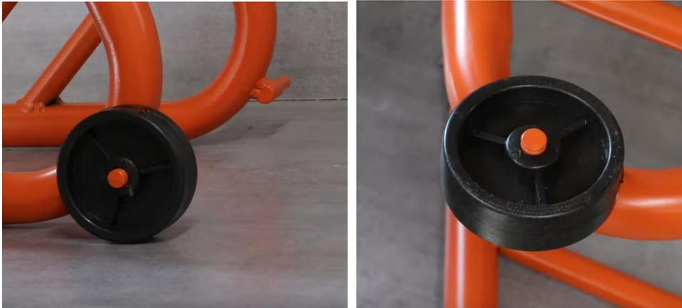
3 - Bloquer la roue grâce à une rondelle étoilée. *Astuce de montage* : utilisez une douille de cliquet de 12mm et un marteau pour installer les rondelles.
