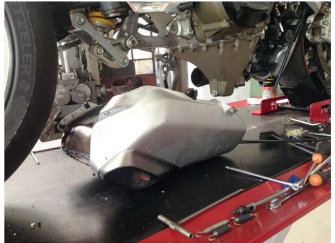
6. Montare valvola Spark utilizzando la vite originale.
