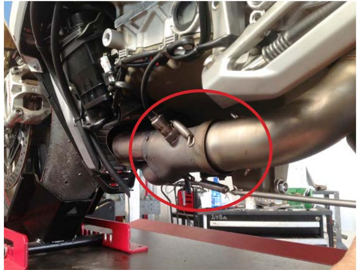
2. Posizionare la staffa dei collettori al telaio senza stringere la vite e montare il secondo collettore.
