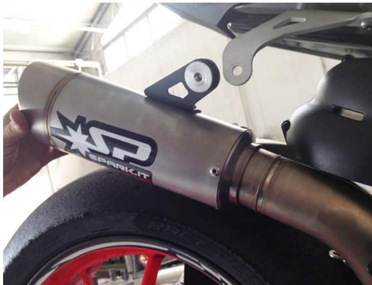
7. Fissare la staffa silenziatore alla staffa telaio usando una vite ed un bullone.
