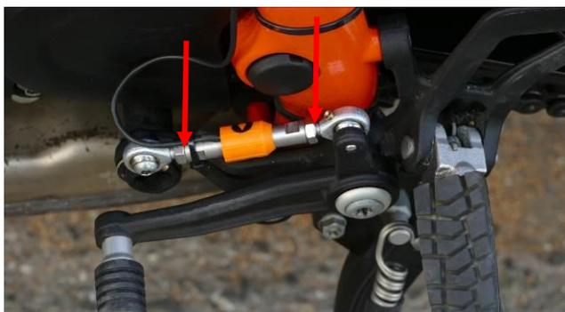
Assurez vous que le capteur et la tige ne touchent rien lors des mouvements Placez le capteur loin de toute source de chaleur. Assurez-vous que le fil fait une légère boucle pour laisser de la marge lorsque le capteur est sollicité La garantie ne couvre pas les fils endommagés.
